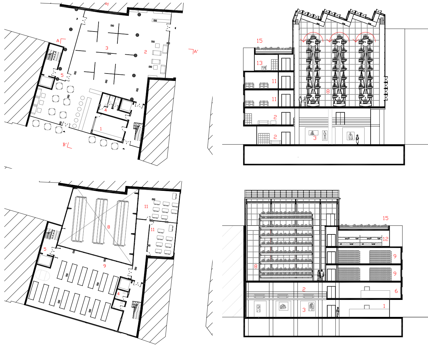
Fig.14 Plan RDC et R+2 de “The Urban Farming Project”. Le plan RDC a un programme tourné autour de la culture avec des un restaurant, une galerie d’art. Le Plan R+2 lui, est consacré à la l’agriculture hors sol. Pour permettre aux deux programmes de fonctionner en synergie ensemble; l’on à séparer les seuils. Le seuil dédié à la production est dans l’arrière-cour du bâtiment tandis que le seuil dédiée aux activités culturelles est en face de l’une des rues principales.
